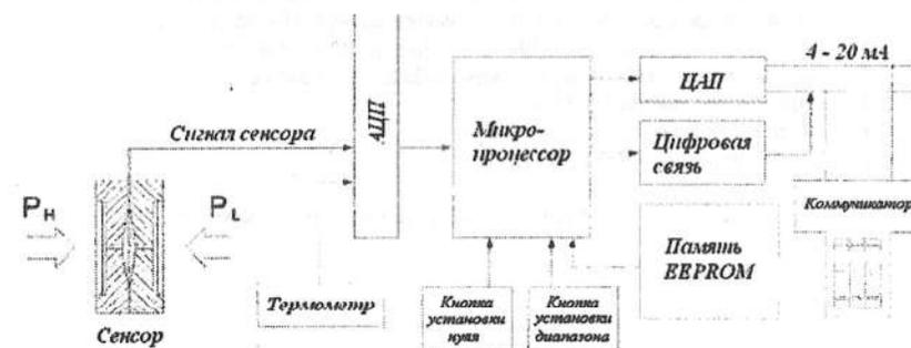
Рисунок 3 – Принципиальная схема АМ-2000
